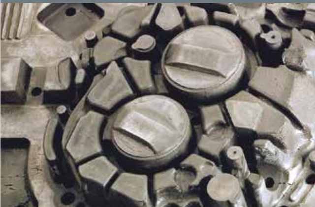
Bauteil hergestellt aus 1.2343 ESU Component made from 1.2343 ESR
